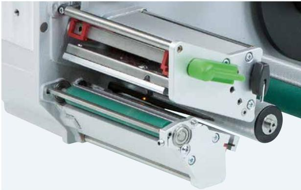
**Alle Druckköpfe sind bei gleicher Breite beliebig austauschbar. Sie werden von der CPU automatisch erkannt und kalibriert. Der Druckabstand zur Anlegekante ist justierbar.**
