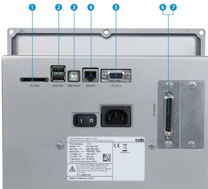
**Digitale I/O-Schnittstellen;** Konform zu IEC/EN 61131-2, Typ 1+3 alle Ein- und Ausgänge mit galvanischer Trennung und Verpolungsschutz, Ausgänge zusätzlich kurzschlussfest
