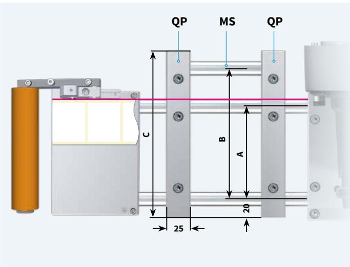
Zur Versteifung bei langen Montagegestangen oder zur Befestigung von Zubehör sind eine dritte Montagegestange MS und zusätzliche Querprofile QP montierbar.
